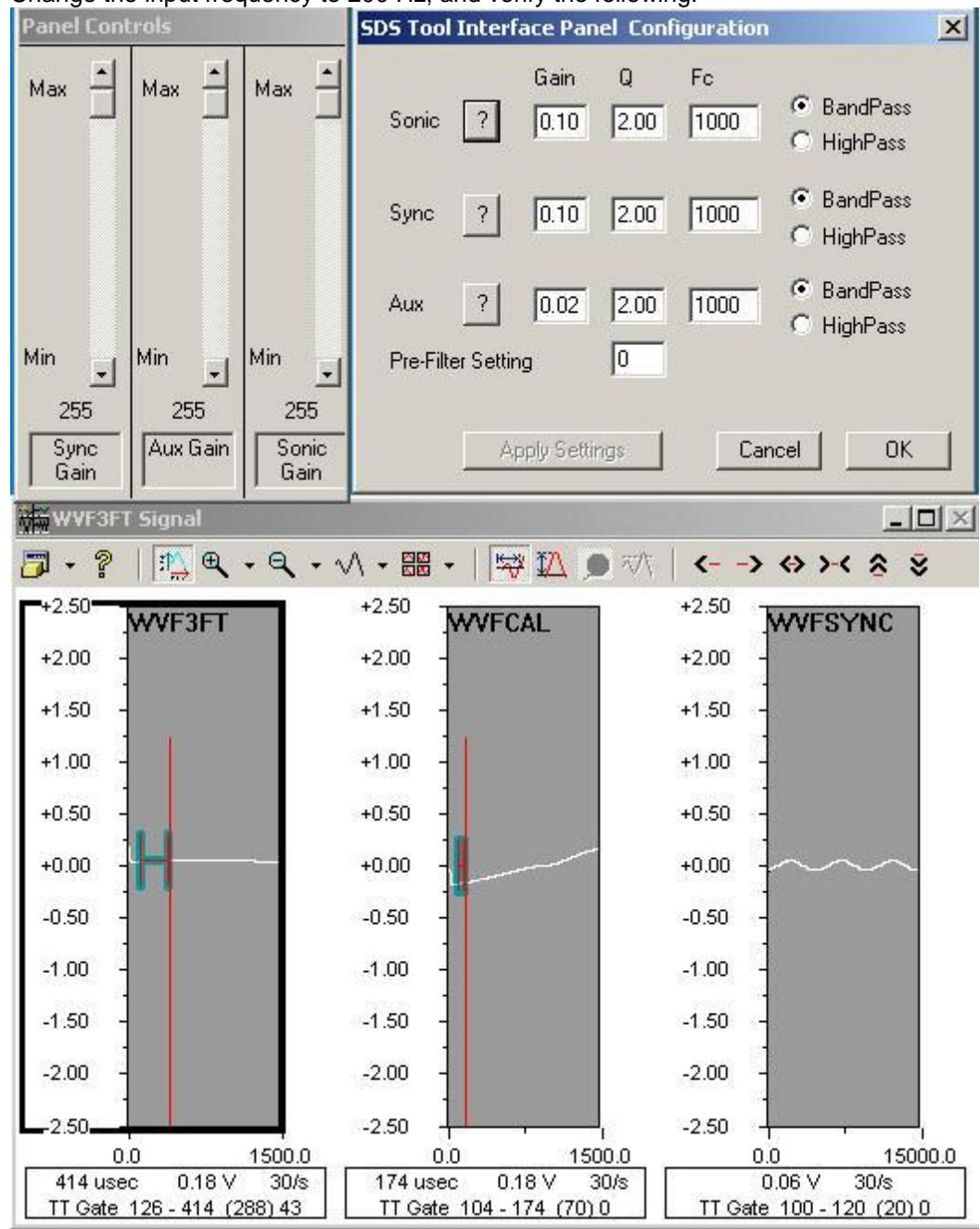
Fig. Ji.8 CBL1-Test Service 200 hz .5Vpp Band Pass
