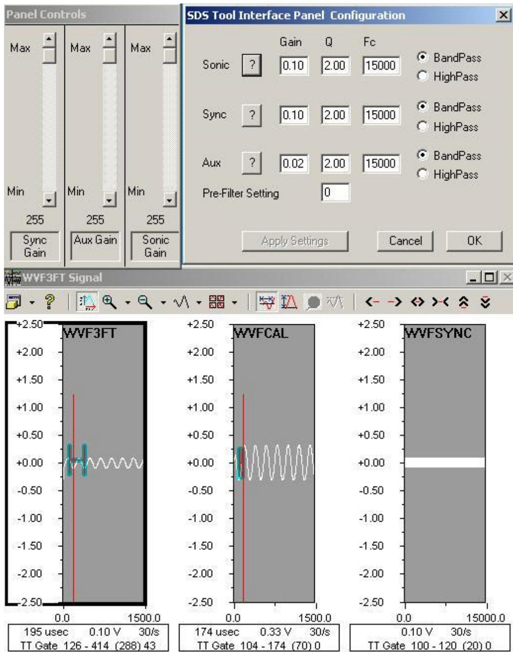
Fig. JI.14 CBL1-Test Service 5 khz .5Vpp Band Pass
