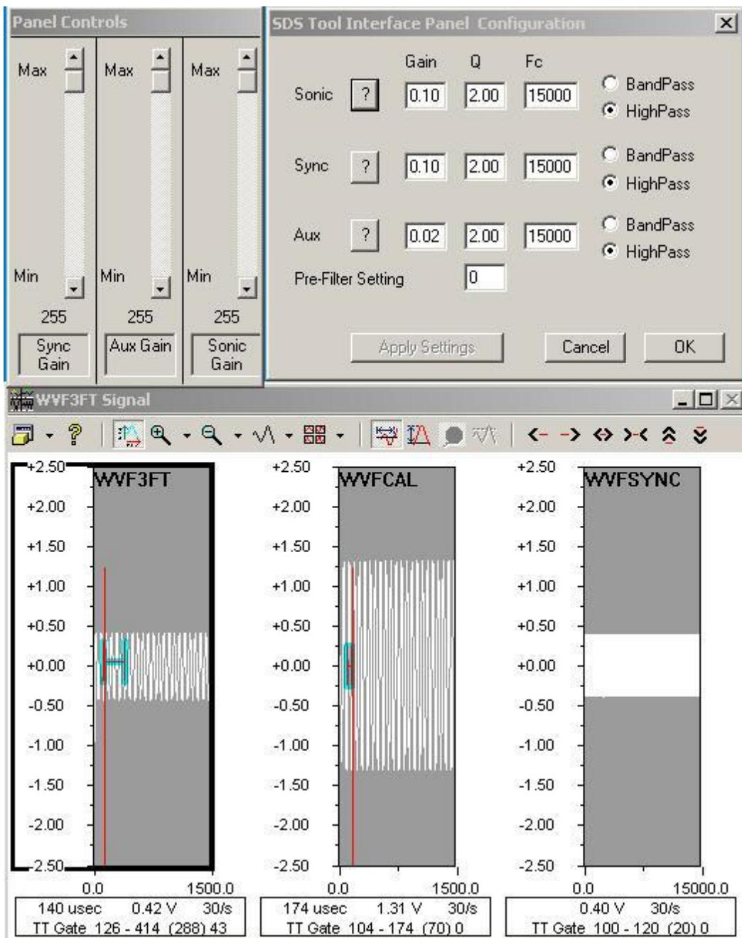
Fig. Ji.9 CBL1-Test Service 15 khz .5Vpp
