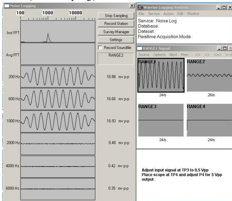
Fig. L.1 .5vpp 1 khz @ TP3
